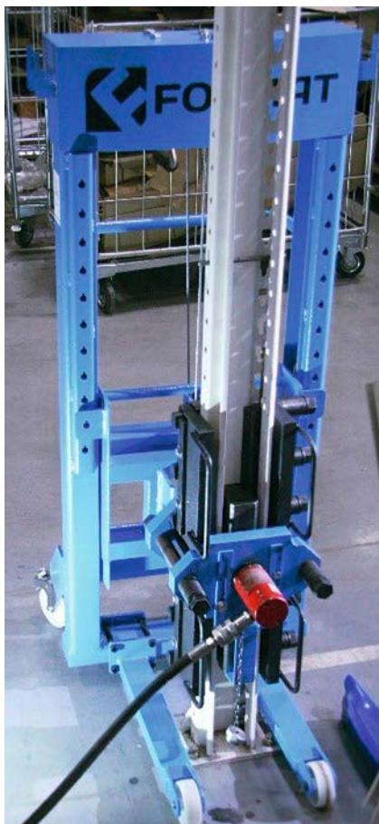
стимые значения остаточных деформаций поверхности несущей стойки. Если они имеют критические значения, то стойка должна выводиться из эксплуатации. Это означает, что на эксплуатирующую компанию возлагается необходимость покупки ремкомплекта, его доставки и замены дефектной стойки. Ключевым фактором при этом является необходимость разгрузки стеллажа и временного выведения товарных единиц, хранимых на складе, из рабочих процессов. Далеко не все логистические службы компаний готовы на
