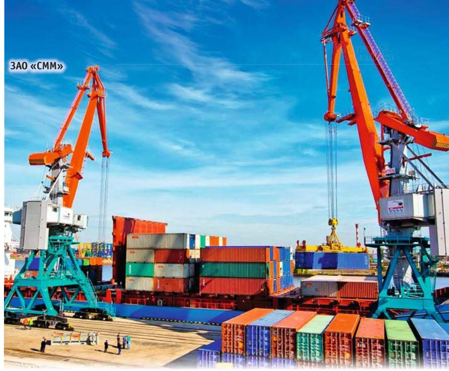
ладая собственной проектной и производственной базой, производит порталные краны г/п от 10 т до 800 т различного назначения: терминальные для обработки навалочных грузов, многоцелевые, краны с бункером для сыпучих грузов и наконец, сверхмощные судостроительные грузоподъёмностью до 2000 т.
